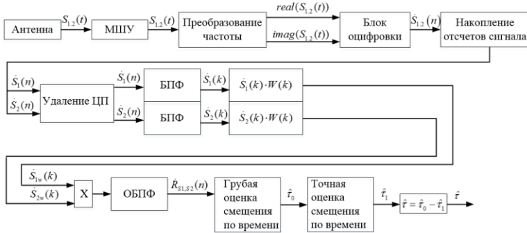
Рисунок 4 – Структурная схема предлагаемого алгоритма оценки смещения по времени принятого сигнала синхронизации
