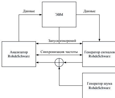
Рисунок 9 – Структурная схема лабораторного макета
