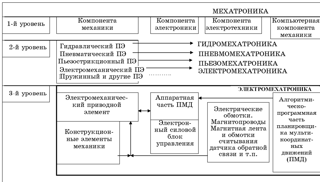
Рис. 1. Графическая иллюстрация понятия «электромехатроника»
